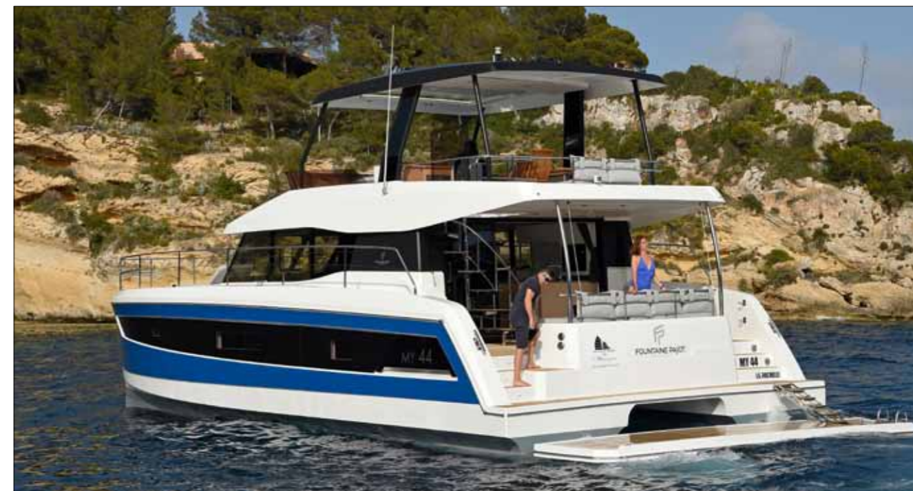
La plate-forme immergeable supporte une annexe de 250 kg. Un étroit escalier se déploie lorsque celle-ci est en position basse.
