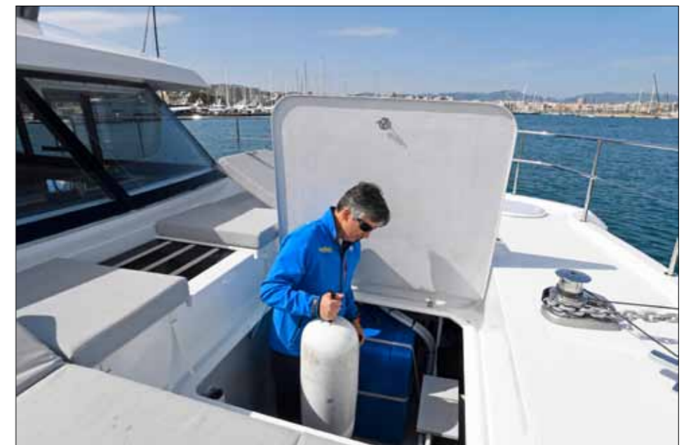
Sous la plage avant, une grande soute sert à stocker les défenses. On devine sur le côté le réservoir à eaux noires.
