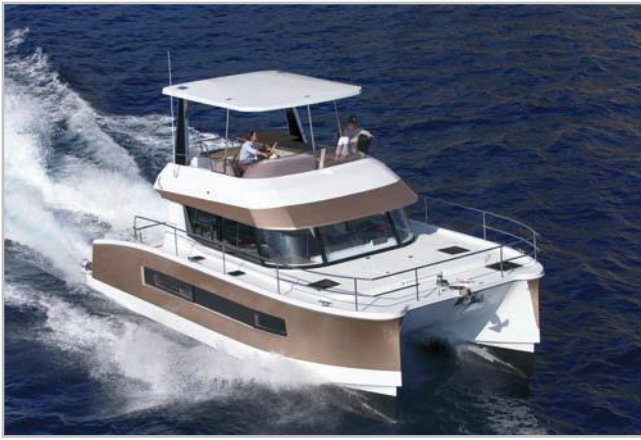
Les coques sont fines à la flottaison, pour prendre rapidement du volume au-dessus grâce à un redan marqué, lequel garantit du volume, mais également casse les projections d'embruns.
