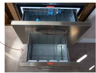
IL FRIGORIFERO A CASSETTONI È IN DINETTE ED È DOTATO DI DUE RITENUTE CHE IMPEDISCONO DI APRIRSI IN NAVIGAZIONE.
