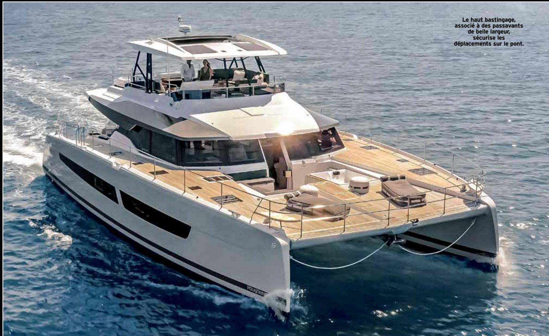
Le haut bastingage, associé à des passavants de belle largeur, sécurise les déplacements sur le pont.
