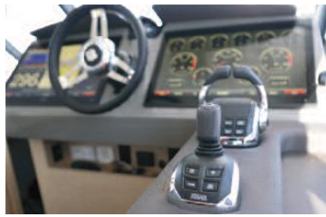
◀ Kormilarski uređaj, Volvove elektronske komande i Garminovi ploteri i instrumenti
