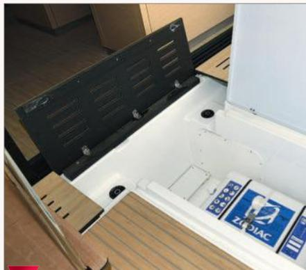
▼ Les nables des réservoirs de carburant mériteraient d'être placés moins près de l'entrée du carré.
