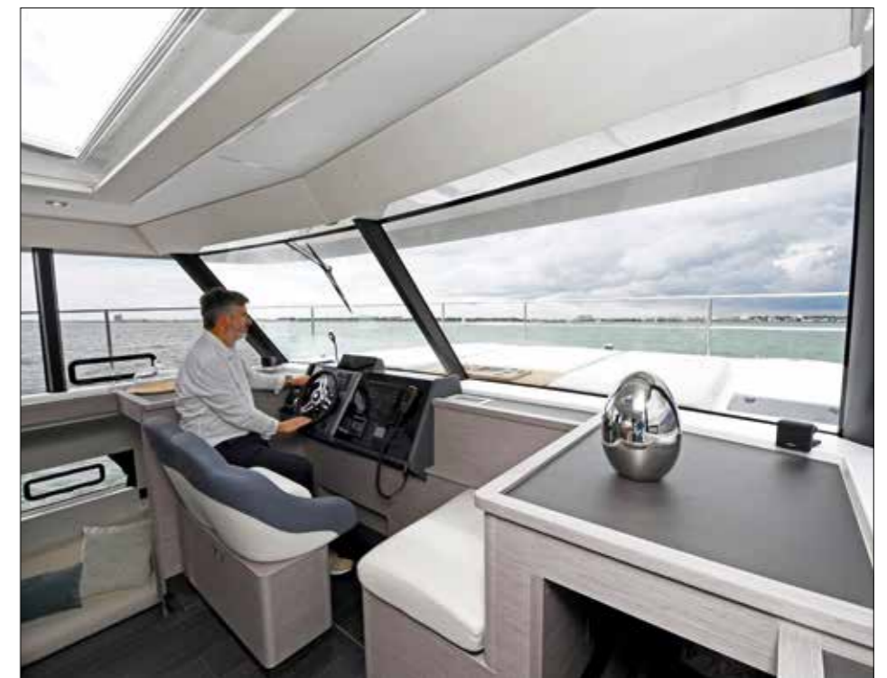
Très proche du pare-brise, le poste de barre dispose de deux fauteuils pilote et copilote et d'une courte banquette pour permettre à l'équipage de vivre la navigation aux premières loges.
